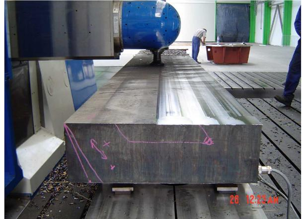
**Bild 9:** Werksfertigung der Grundschiene
