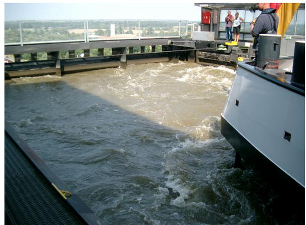
**Bild 2:** Schraubenwasser zu Beginn eines Ausfahrversuchs im Oberwasser
