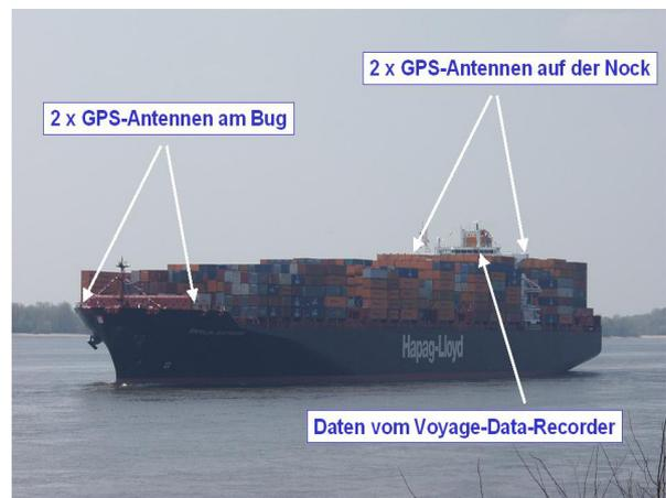
**Bild 7:** Positionen der geodätischen GPS-Antennen am Beispiel der CMS BERLIN EXPRESS von HAPAG LLOYD (HLCL) Foto: BAW-DH
