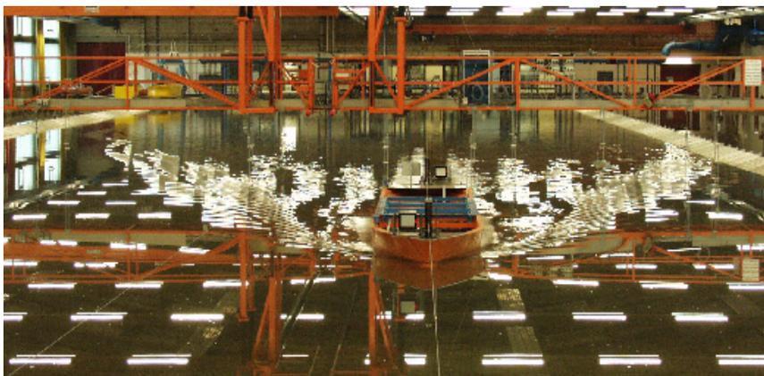
**Bild 5:** Systemversuch zur Fahrt in seitlich begrenztem Flachwasser mit dem MEGA-JUMBO mit etwa  $v_{S,MODELL} = 1,0$  m/s ( $v_{S,NATUR} = 12,5$  kn; Trapezprofil  $n = 15$ ;  $n_T = 10 / 20$ ).
