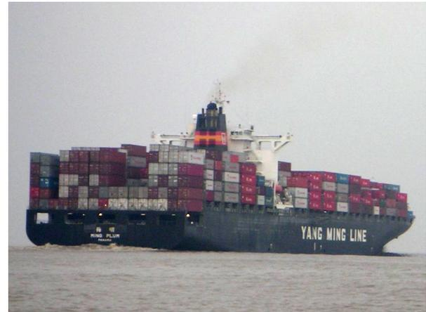
**Bild 9:** CMS „Ming Plum“ bei Fahrt auf der Unterelbe mit eingetauchtem Spiegelheck und sehr schlankem Unterwasserschiff im Bugbereich, Foto: BAW-DH
