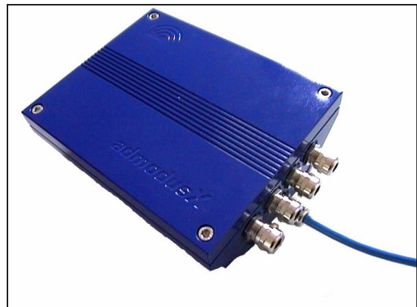
**Bild 1:** *Admodus*-Hardwaremodul zur Ultraschall-Signalauswertung
