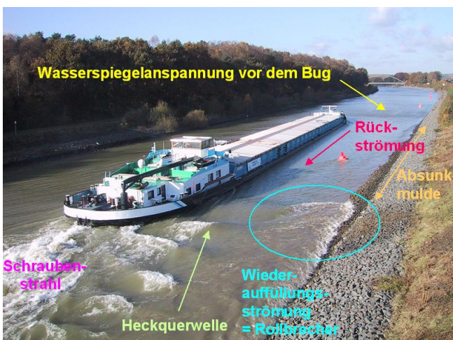
Bild 2: Schiffserzeugte Wellen und Strömungen während der „Kanalfahrt“ - rechts: am Ufer gemessene Wasserspiegelauslenkung während einer Schifffahrt
