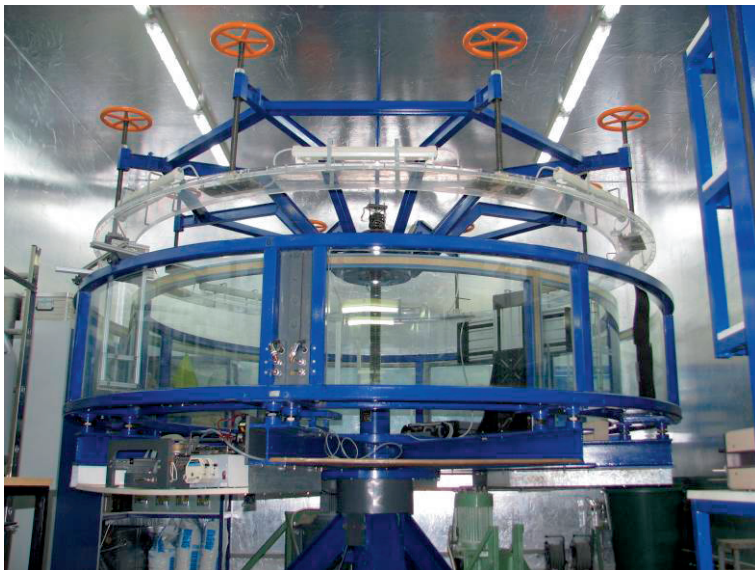
Abbildung 1: Das Kreisgerinne in der Klimakammer am IWW
