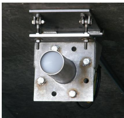
Abbildung 2: Radarsensor (Bremenports)
