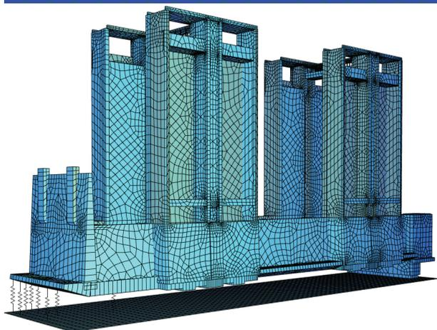
**Abbildung 13:** 3-Dim. Berechnung der Baugrube und des bestehenden Schiffshebwerks
