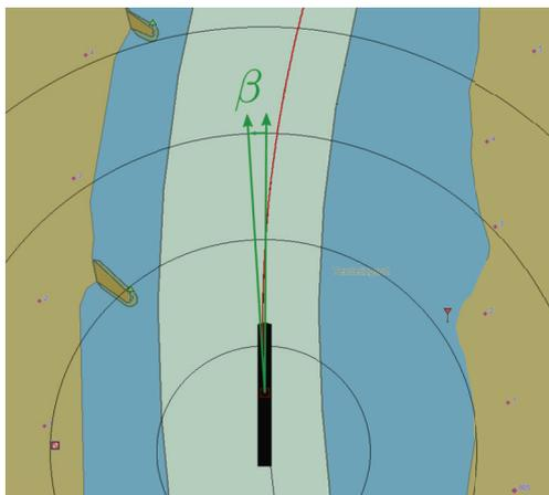
Abbildung 10: Automatische Bahnführung mit dem nötigen Driftwinkel  $\beta$
