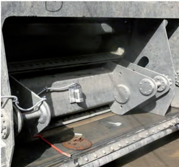
c) Beschleunigungssensor am Füllschütz eines Stemmtors und
