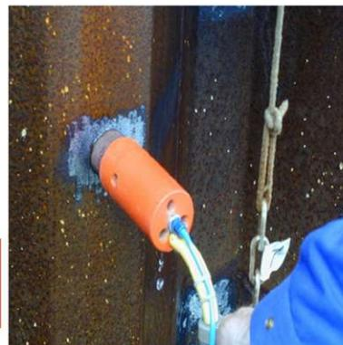
**Abb. 8.1:** Impuls-Echo-Methode mit Auswertung durch Zählvorgang
