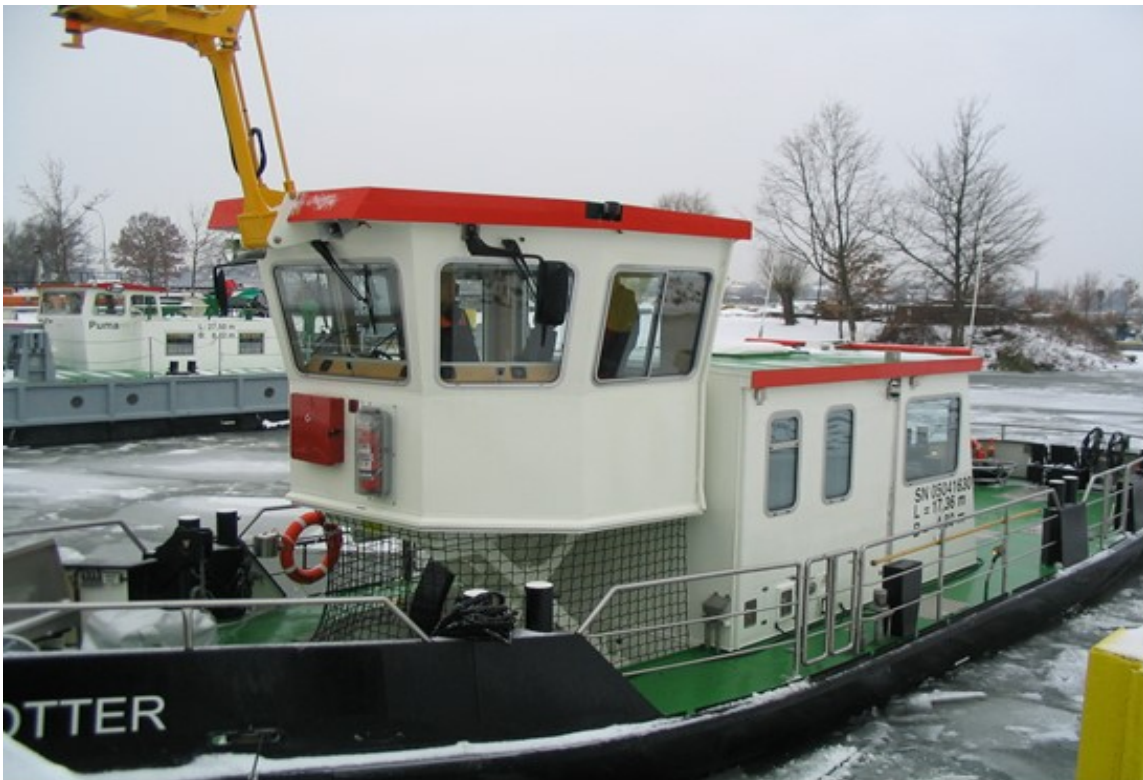
Abbildung 4: Test höhenverstellbares Steuerhaus auf Scherenhubtisch bei Abnahme 2009
