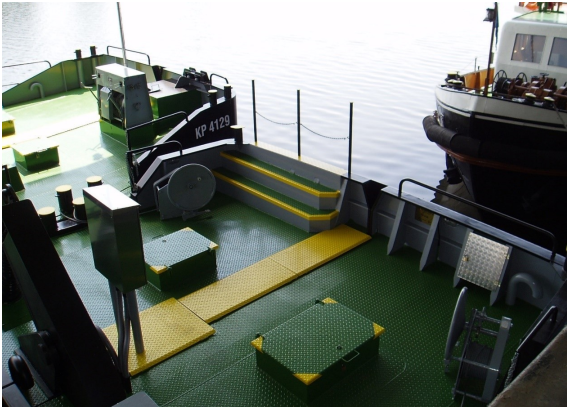
Abbildung 15: Hinterschiffdeck mit Steuerschrank, Spannwinden, Übergang Schubboot
