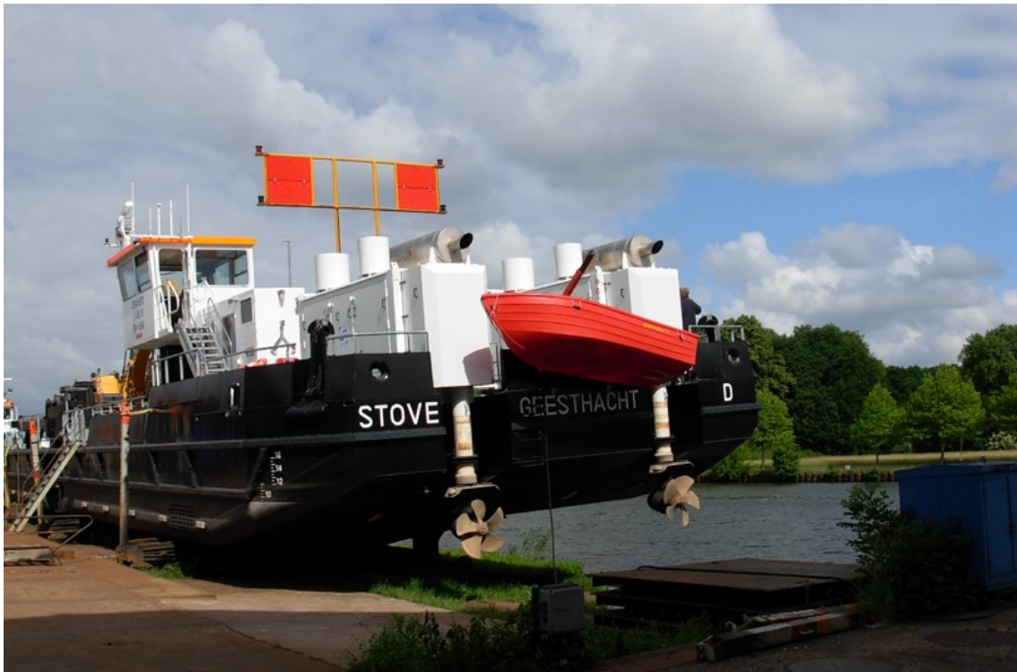
Abbildung 1: SG Stove Antrieb und Beiboot
