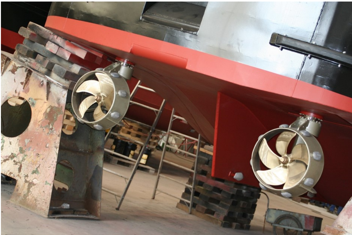
Abbildung 6: Ruderpropeller mit Drehdüse
