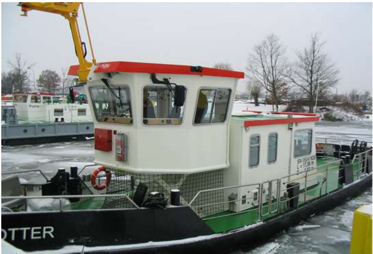
Abbildung 4: Test höhenverstellbares Steuerhaus auf Scherenhubtisch bei Abnahme 2009
