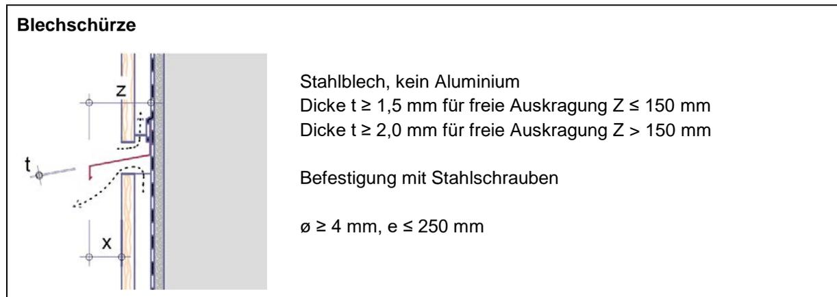
**Prinzipskizze 14:** Ausführung und Befestigung von horizontalen Brandsperrn (Z = Maß der Auskrägung, X = Mindestauskrägung Brandsperrn, siehe Tabelle 3)
